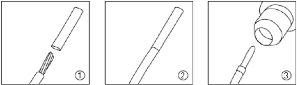
В этом случае следует придерживаться принципа: внутренний диаметр трубки до усадки должен быть больше, чем основание, на которое будет производиться усадка, на 10-20 %, а номинальный диаметр трубки после усадки должен быть меньше фактического диаметра основания на 10-20 %. Только при этих условиях будет обеспечено плотное прилегание трубки к изделию. При выборе длины следует учитывать, что ТУТнг дает продольную усадку.
